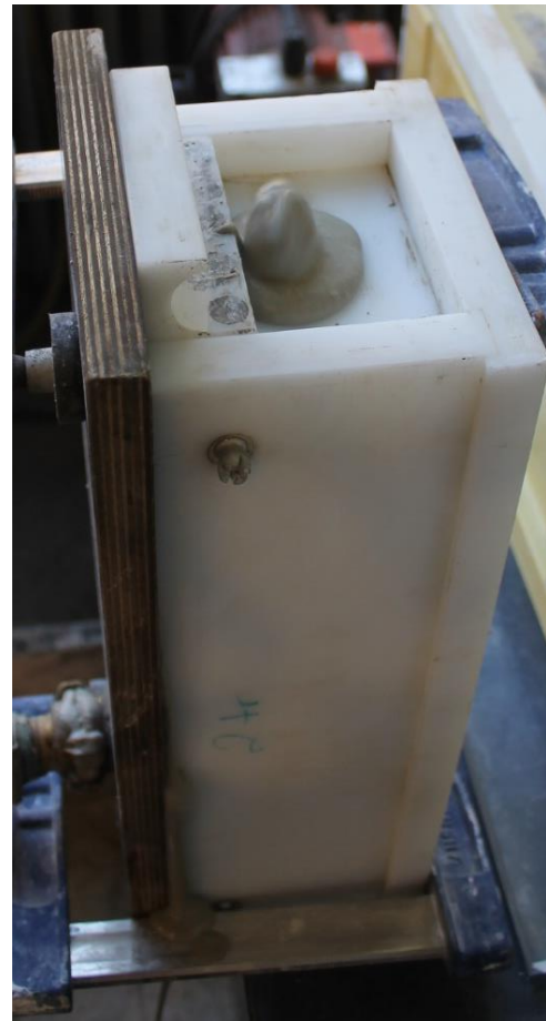
Abbildung 15: Mörtelaustritt nach Injektionsdurchlauf
