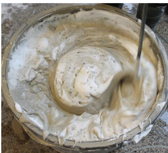
Abbildung 10: Unterheben des Schaums
