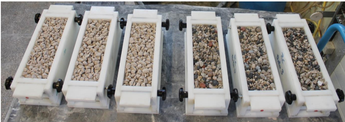
Abbildung 21: Mit Granulaten befüllte Balkenschalungen
